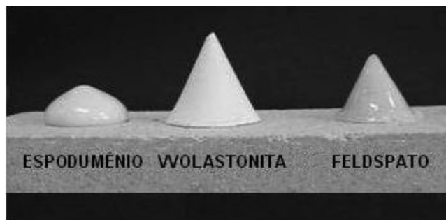
Figura 5: Teste de cone de fusão para formulações de 100% de fundente. Taxa de 150 °C/h, temperatura máxima 1240 °C e 30 min de patamar.
