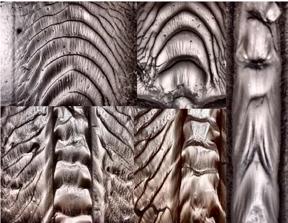
Figura 168 - Imagens de depósitos onde é possível identificar sobrepostos as ripples sulcos longitudinais (furrows).
