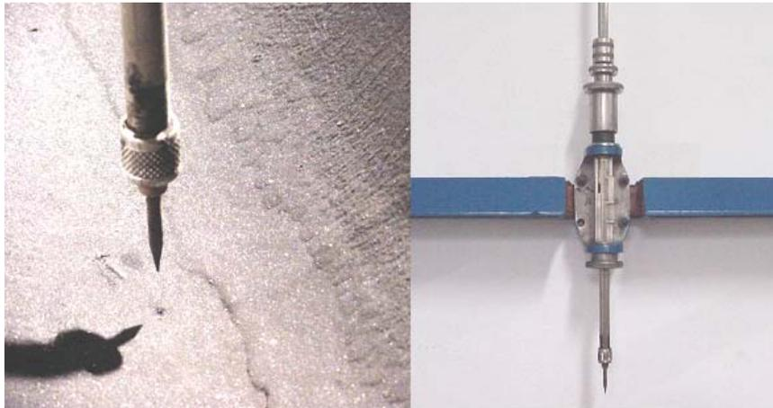
**Figura 36 - Detalhe da ponta linimétrica.**
