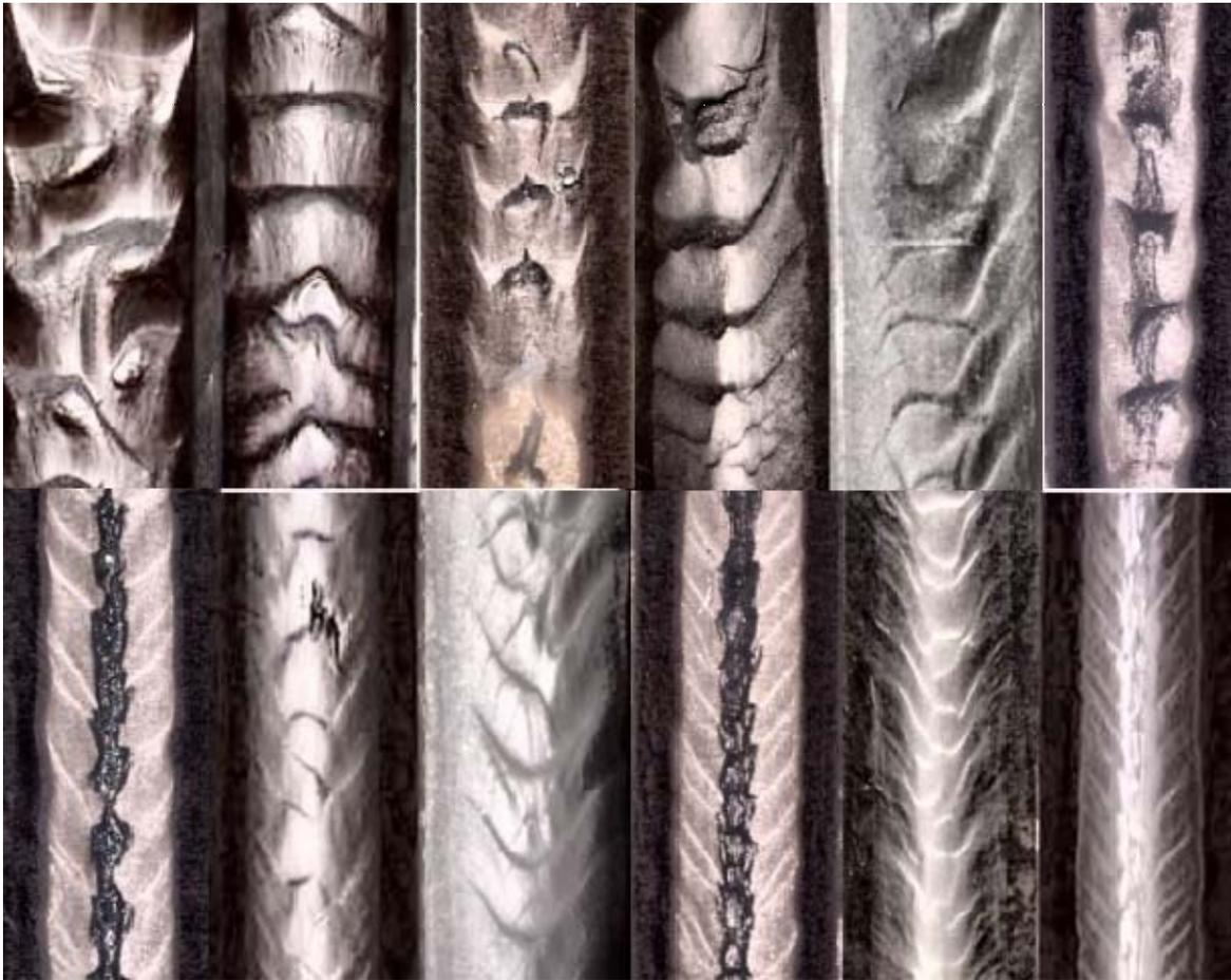
**Figura 157– Seqüência ideal de formas de leito constatadas nos ensaios da esquerda para direita, inicialmente na linha superior passando a linha inferior. São elas ripples lineares que progressivamente vão se deformando até se tornarem com crista sinuosa, no sentido do fluxo passam a assumir a forma lingüóide diminuindo tanto a distância entre as cristas como a amplitude.**
