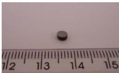
Figura 3.10: Amostra processada a 7,7 GPa e 550 °C na prensa de 400 tf.
