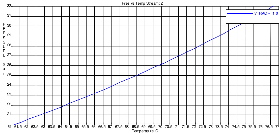
Figura 5.5: Curva de ponto de orvalho da HS19 em condição extrema.
