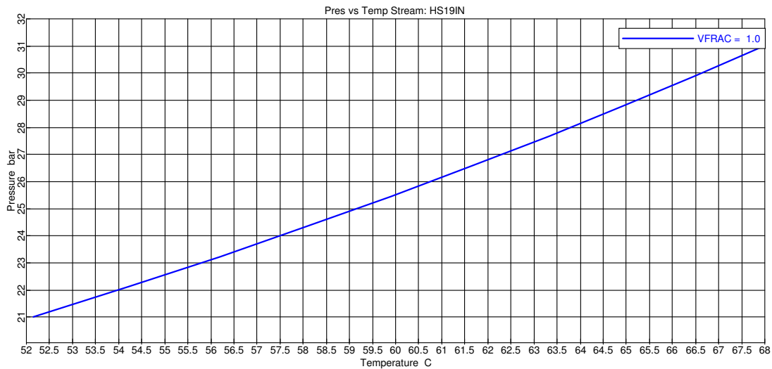
Figura 5.4: Curva de ponto de orvalho da HS19, indicando que esta corrente, com a composição do caso base, a 28barg (2900kPa) de pressão, trocando calor com a CS3 a 72,9°C, não sofrerá condensação.
