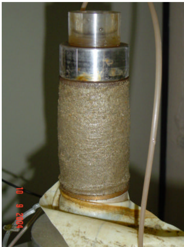
Figura 4-13: Corpo de prova R-200 após o ensaio triaxial.
