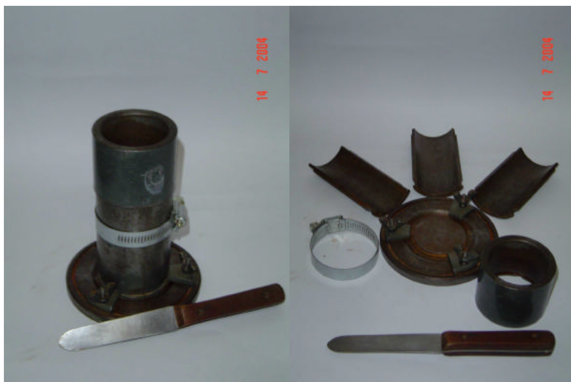
Figura 3-7: Ferramentas utilizadas na moldagem de corpos de prova reconstituídos.
