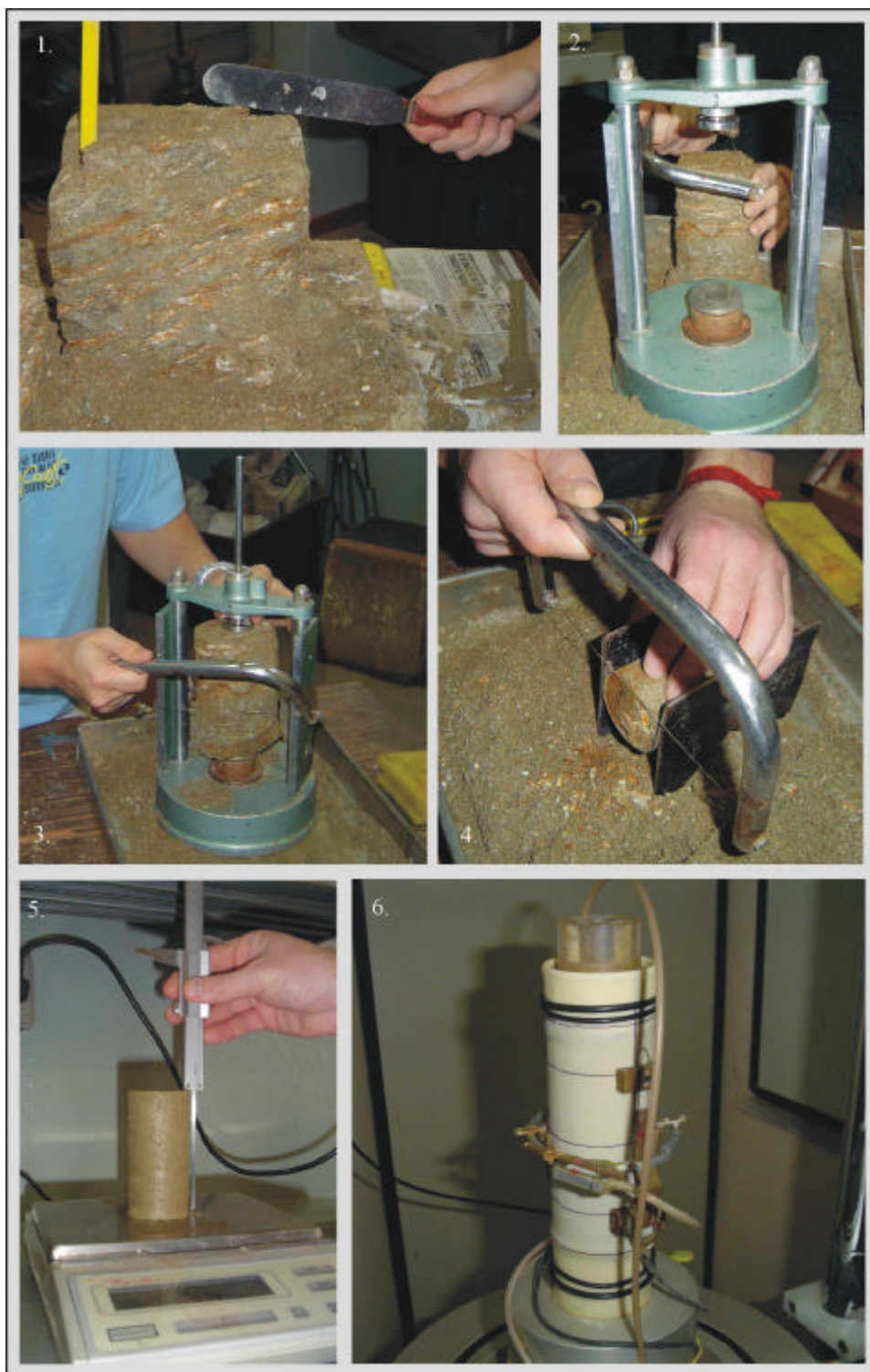
Figura 3-6: Procedimento de talhagem de amostras indeformadas: 1. retirada de porção do bloco indeformado; 2. regularização do topo e base da amostra; 3. talhagem no torno; 4. ajuste da altura do corpo de prova; 5. medição de altura diâmetro e massa (ilustração com corpo de prova reconstituído); 6. corpo de prova montado no equipamento com sensores de efeito Hall posicionados.
