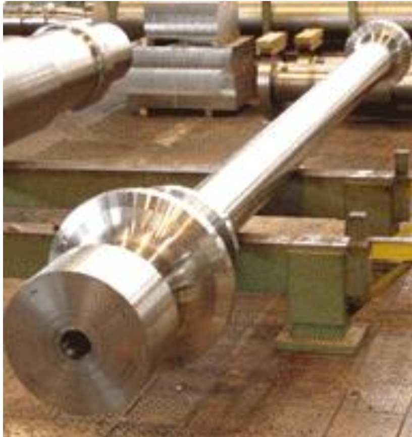
Figura 7 - Eixo forjado, usinado e trepanado para aplicação em aerogerador. Cortesia: Villares Metals S.A..
