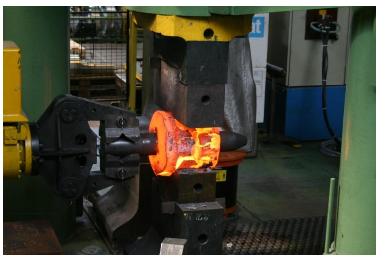
Figura 58 - Último passe do quarto ciclo de forjamento.
