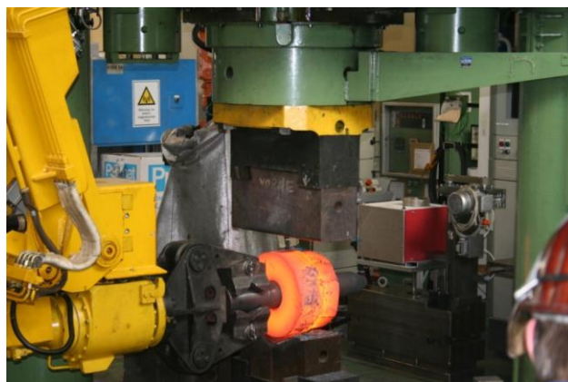
Figura 55 - Posicionamento para início do segundo ciclo de forjamento.
