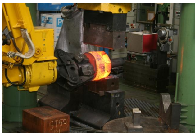
Figura 54 - Último recalque do primeiro ciclo de forjamento.
