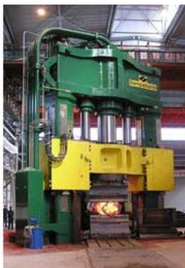
Figura 3 - Forjamento em Matriz Aberta de eixos de grande dimensão (SIEMPELKAMP, 2012).
