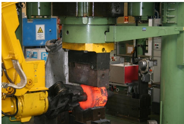
Figura 56 - Último passe do segundo ciclo de forjamento.
