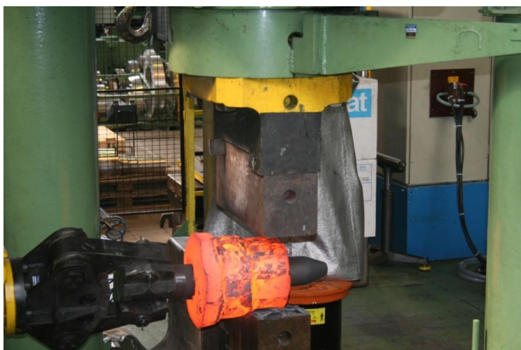
Figura 57 - Último passe do terceiro ciclo de forjamento.
