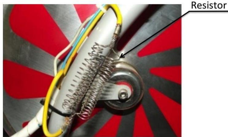
Figura 3.4 – Resistor de carga.
