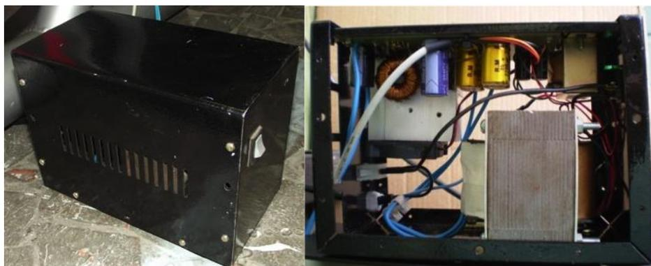
Figura 3.3 – Fonte de alimentação para a tensão de campo no alternador.
