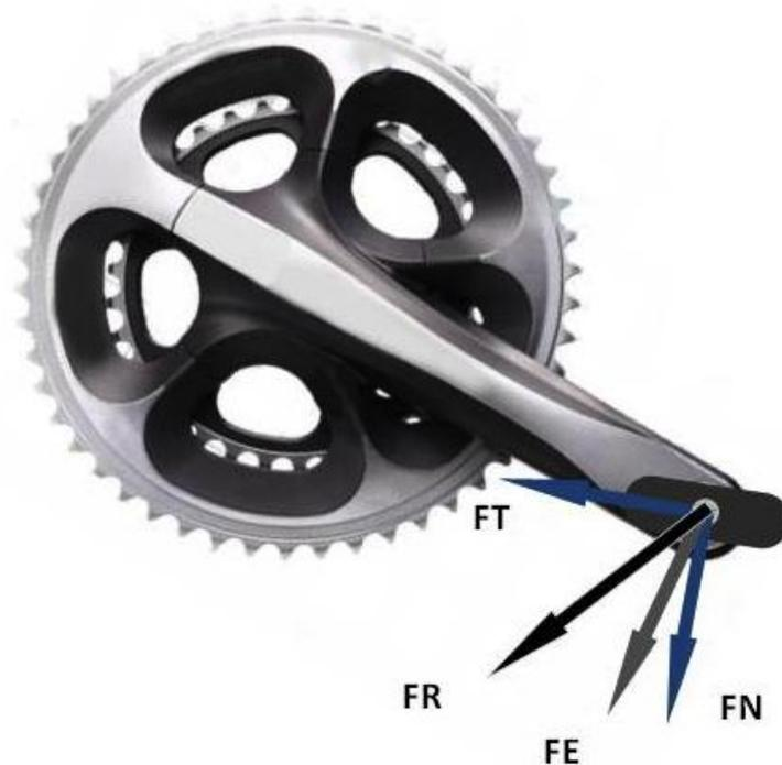
Figura 2.23 – Ilustração das forças que atuam no ciclo da pedalada: FN=Força normal, FT=Força tangencial, FR=Força resultante e FE=Força efetiva [Adaptado de Bini, 2011b].
