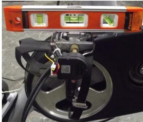
Figura 3.8 – Calibração dos pedais.
