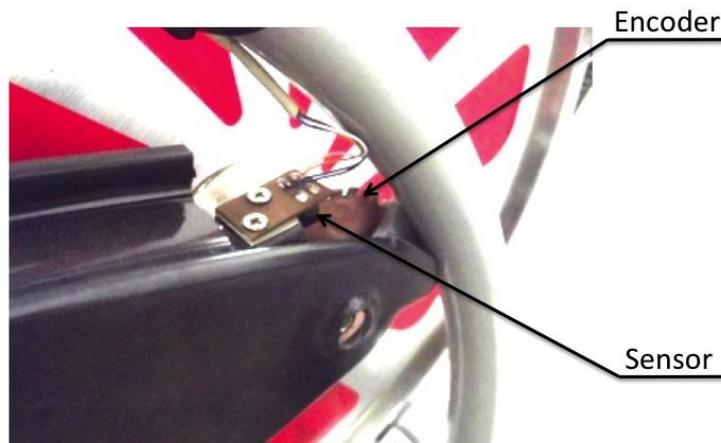
Figura 3.5 – Encoder para medição de velocidade angular.
