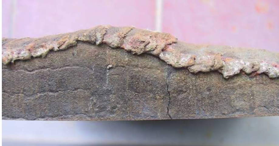
Figura 3.17. Trinca longitudinal de face (Adaptado de NOGUEIRA, 2006)
