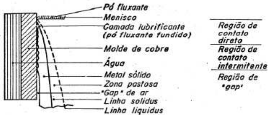
Figura 3.5. Desenho esquemático mostrando as diferentes zonas existentes entre a superfície da parede do molde e a pela solidificada (Taconi, 2007)
