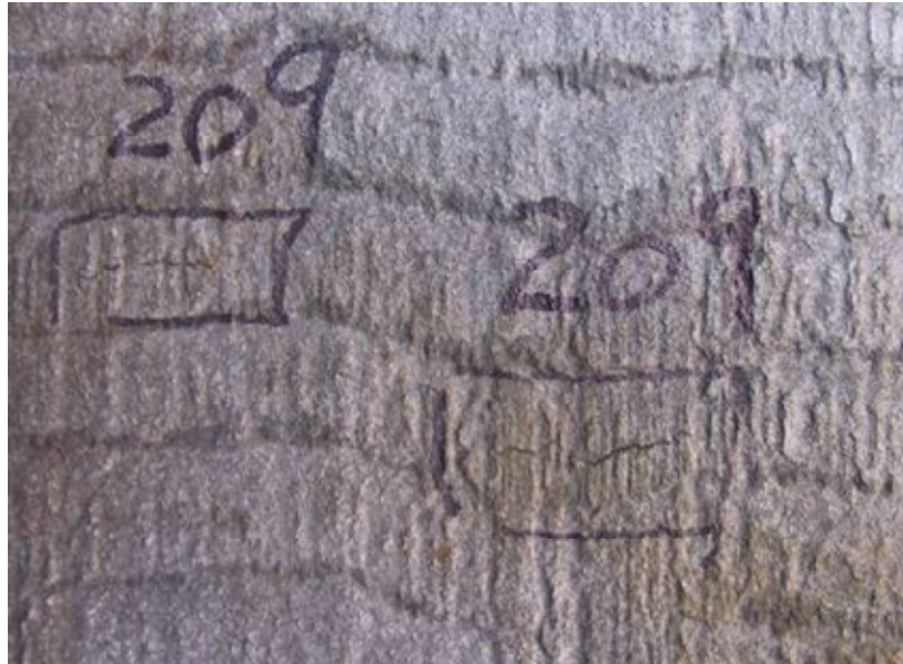
Figura 3.18. Trinca transversal de face (Adaptado de NOGUEIRA, 2006)
