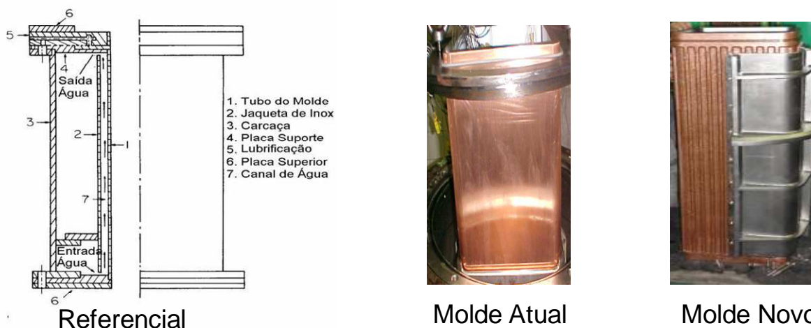
Figura 4.2. Fotos dos dois tipos de moldes e um referencial de montagem de padrão utilizado atualmente.
