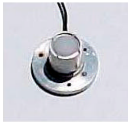
Figura 4.17 - Piranômetro Fotovoltaico com uma cobertura difusora
