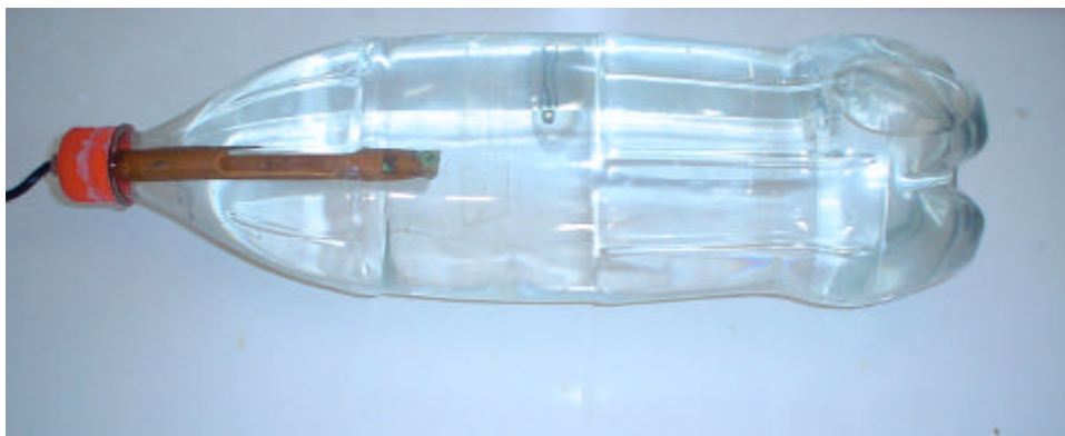
Figura 4.2- Foto ilustrativa de uma garrafa contendo água e do tubo de cobre no qual foi inserido um sensor de CI para medida de temperatura.
