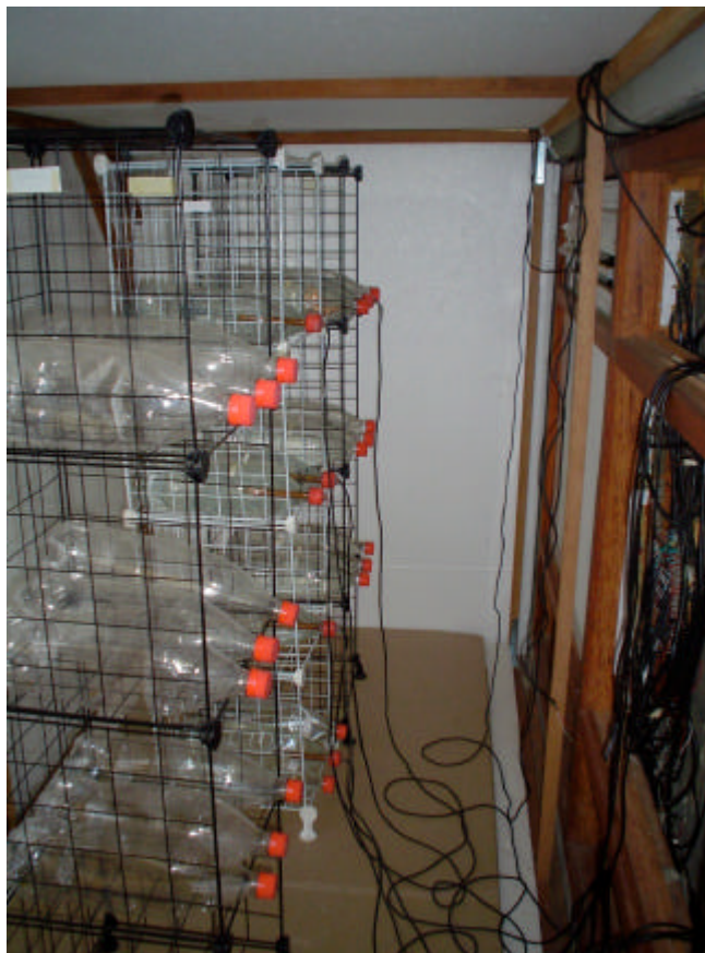
Figura 4.3- Foto do interior do calorímetro com diversas garrafas nas estantes
