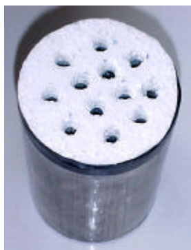
Figura 4.9 – Cilindro de Alumínio usado para calibração. Dimensões aproximadas do cilindro: altura = 150 mm, diâmetro = 100 mm e diâmetro_furo = 6 mm.
