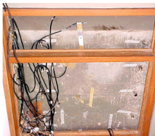
Figura 4.8 – Vista da parede interna do coletor solar
