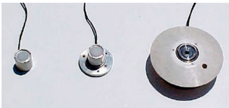
Figura 4.18 - Piranômetros fotovoltaicos e térmico na mesma superfície horizontal
