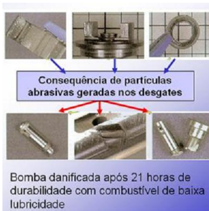
Figura 16 – Desgastes causados por partículas abrasivas em bombas injetoras por diesel de baixa lubrificidade. Fonte: Rocha (2005).
