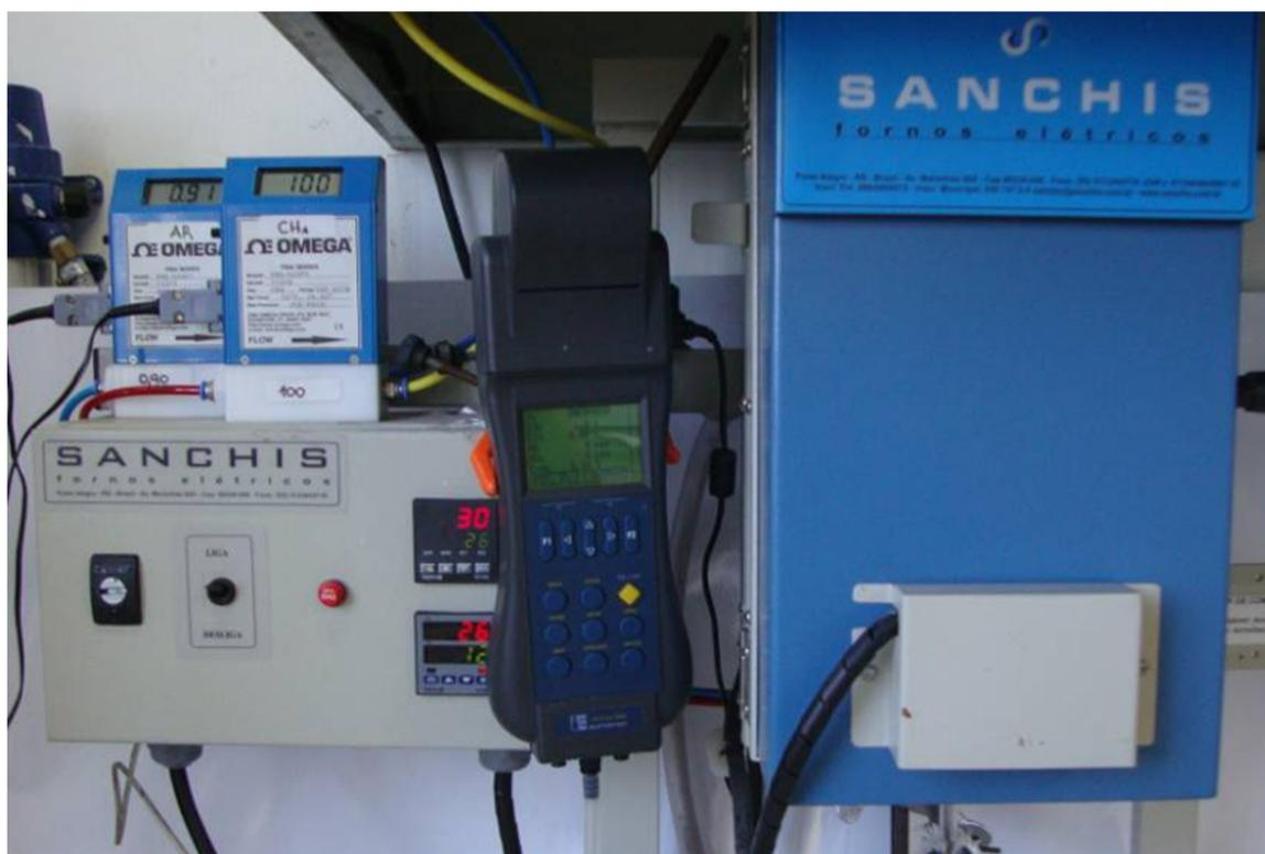
Figura 5.3. Montagem do equipamento de avaliação da atividade catalítica.
