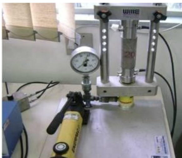
Figura 4-48: Equipamento adaptado para realização de ensaio sísmico com carga aplicada.
