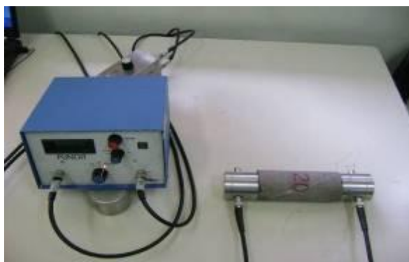
Figura 4-47: Aparelho utilizado na realização dos ensaios sísmicos.
