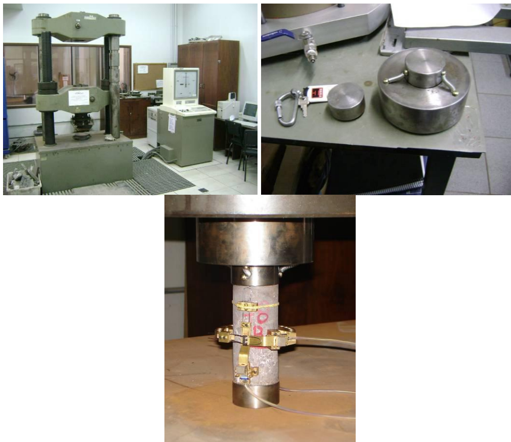
Figura 4-16: fotografias dos equipamentos de ensaio: topo esquerda, prensa para 200 ton. utilizada, topo direita: pistões de carga e rótula usinadas para os ensaios e centro abaixo: sensores de efeito hall para medição local de deslocamentos.
