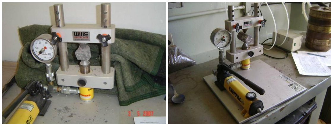
Figura 4-7: equipamento para execução dos ensaios de carga puntiforme (a) corpo de prova irregular e (b) corpo de prova cilíndrico.
