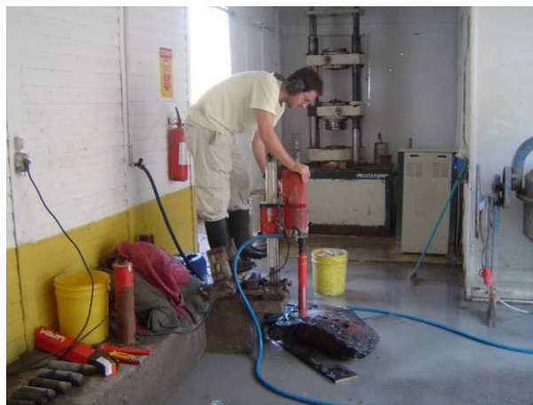
Figura 4-1: amostragem de testemunhos de blocos provenientes da escavação.
