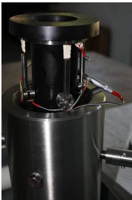
Figura 4-24: detalhe da instrumentação local para medição de deslocamentos radiais.
