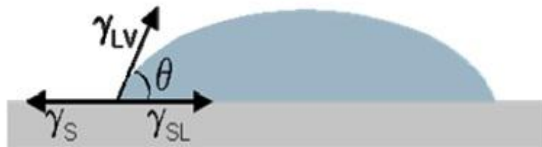
Figura 5: Definição de ângulo de contato \theta entre uma gota líquida e uma superfície plana e horizontal. \gamma_S e \gamma_{LV} são a energia de superfície do sólido e a tensão superficial do líquido em equilíbrio com o vapor; \gamma_{SL} é a energia da interface sólido-líquido [adaptada de 13].
