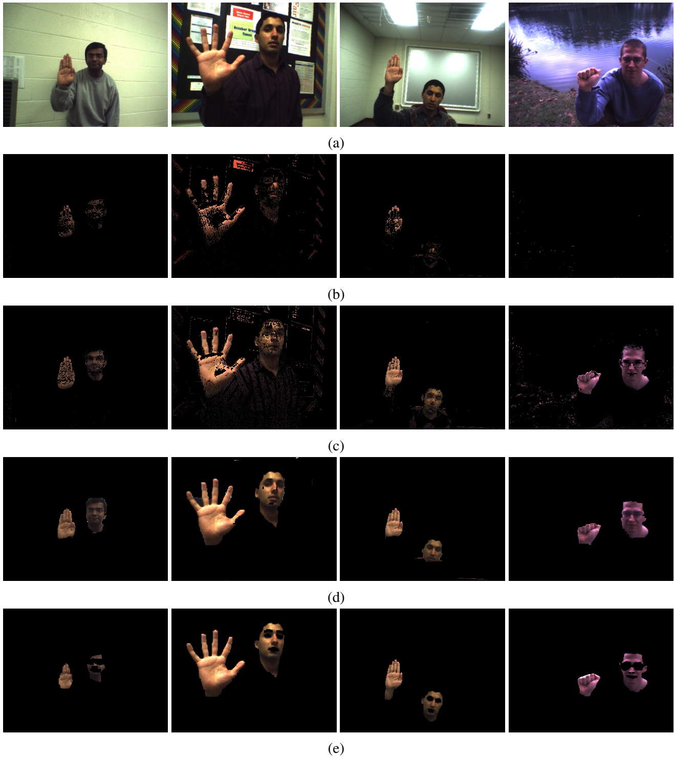
Figura 6.6: Comparação visual do método proposto de detecção de pele. (6.6a) imagem original, (6.6b) limiarização HSV (DARDAS; GEORGANAS, 2011), (6.6c) classificador de Bayes (KAKUMANU; MAKROGIANNIS; BOURBAKIS, 2007), (6.6d) método proposto, (6.6e) ground truth .
