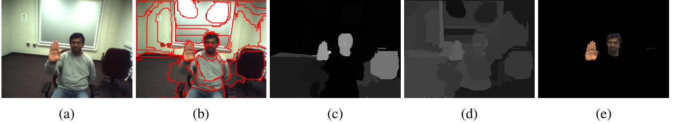
Figura 5.3: Resultados preliminares do método de detecção de pele proposto neste trabalho. (5.3a) imagem original; (5.3b) resultado da segmentação de texturas; (5.3c) similaridade de cor; (5.3d) similaridade de textura (regiões mais claras possuem maior similaridade); (5.3e) resultado final da classificação.
