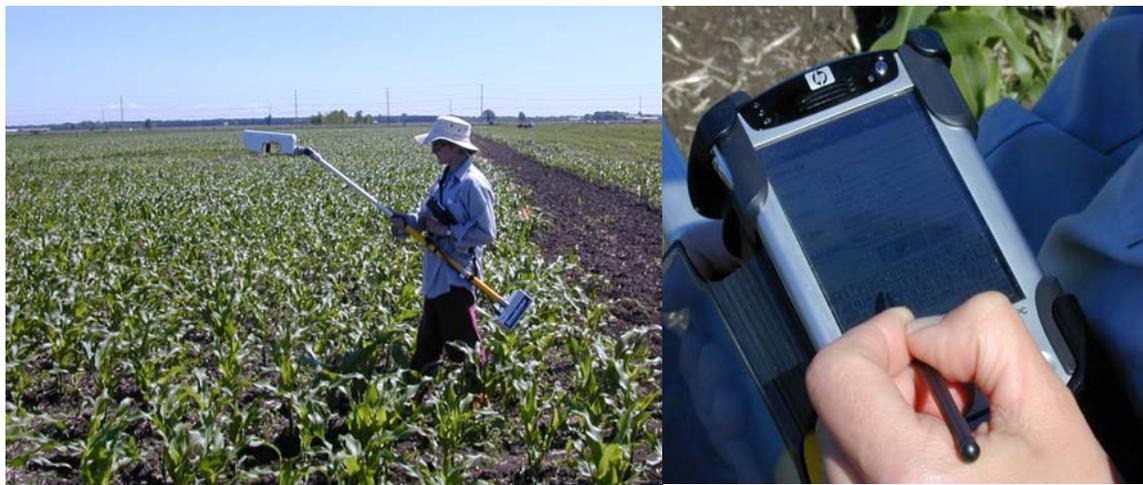
**Apêndice 6.** Determinação da reflectância do dossel de milho com o radiômetro Green Seeker, modelo 505.
