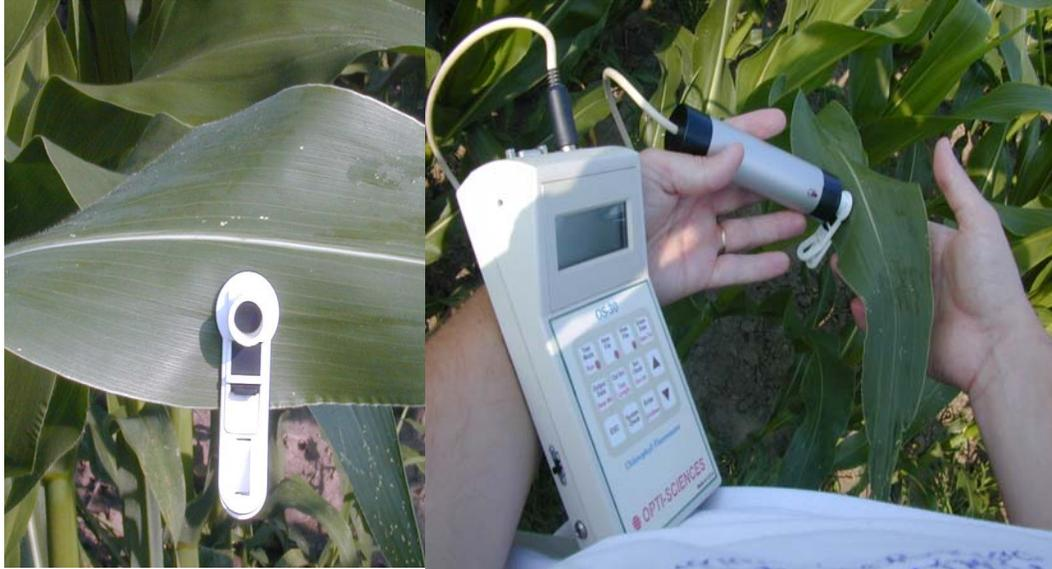
**Apêndice 4.** Determinação da fluorescência na folha de milho com o fluorômetro modelo OS-30.
