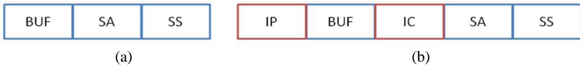
Figura 2.7 – Pipeline no roteador RaSoC. (a) RaSoC original. (b) RaSoC modificado.
