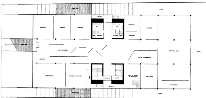
Fig. 878: planta pavimento de acesso (1ºsubsolo).
