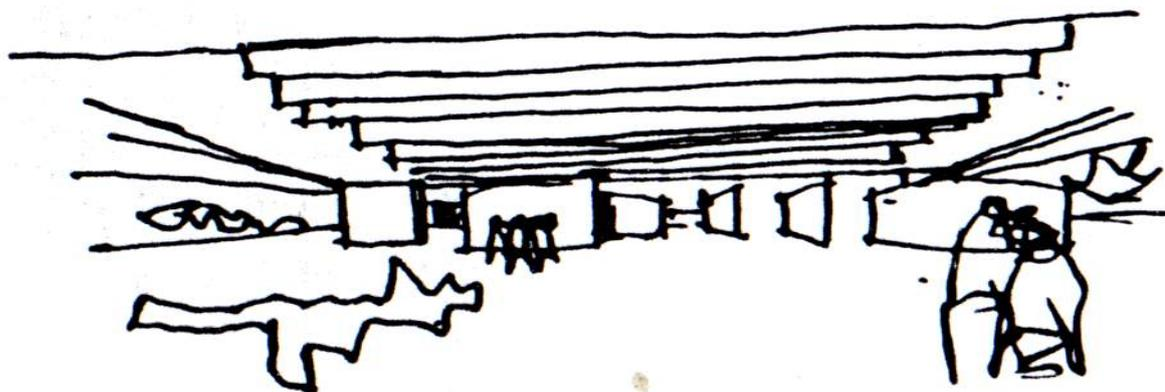
Fig. 864: vão livre horizontal que separa a torre do embasamento.
