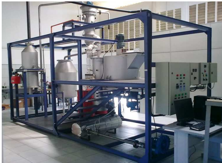
Figura 4: Planta pirolítica utilizada para a obtenção de bio-óleos no Laboratório de Biomassa e Biocombustíveis da UFRN.
