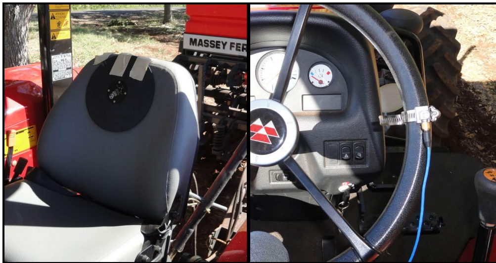
Figura AP2.2 – Figuras dos locais de aplicação dos acelerômetros no encosto e no volante.
