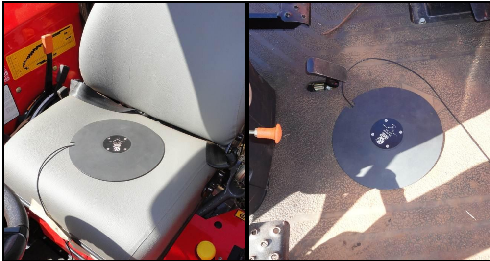
Figura AP2.1 – Figuras dos locais de aplicação dos acelerômetros na base do assento e assento do operador.
