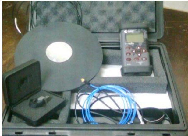
Figura 2.3 – Medidor QUEST VI400-Pro e transdutores utilizados nas medições.
