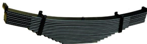
Figura 3.1 – Modelo de suspensão por feixe de molas trapezoidal.
