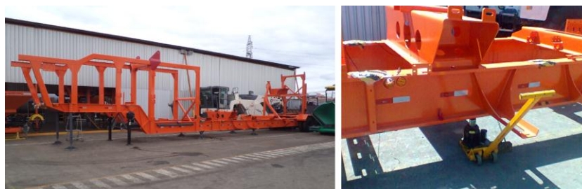
Figura 4.14 – Apoio do chassi em macaco hidráulico no centro do chassi. Apoio aplicado no lado direito e esquerdo.
