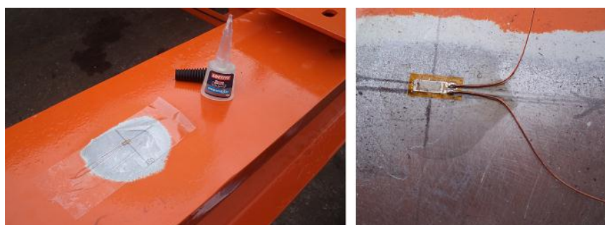
Figura 4.13 – Extensômetro aplicado ao chassi.
