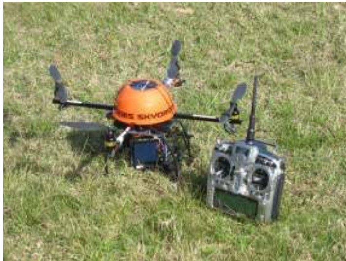
Figura 5.2: Protótipo MikroKopter configurado com 4 hélices. Fonte: DELET (Departamento de Engenharia Elétrica, UFRGS).
