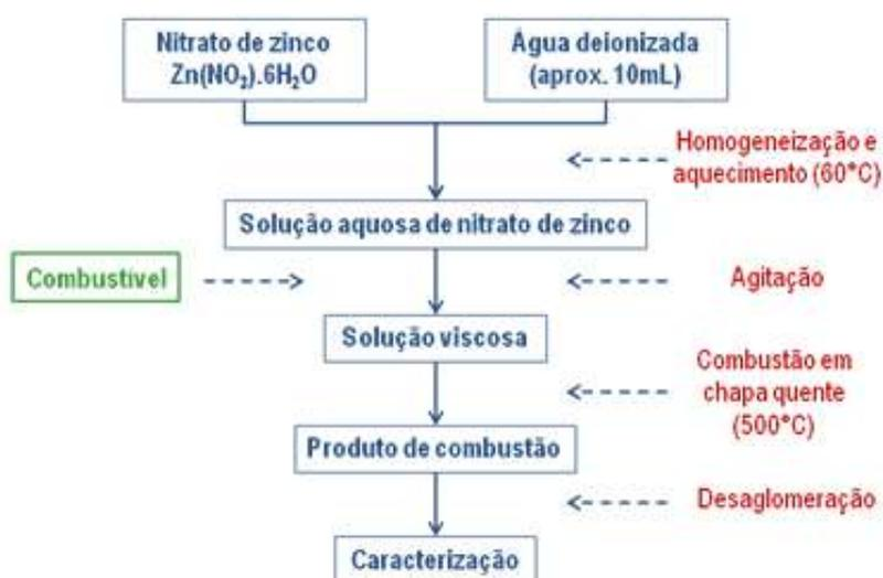
**Figura 4. 2:** Fluxograma do procedimento experimental da síntese de ZnO.
