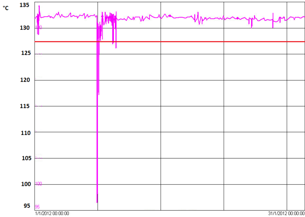
Figura 14: Temperatura do vapor para o refervedor em janeiro de 2012. Temperatura de controle: 128°C.
