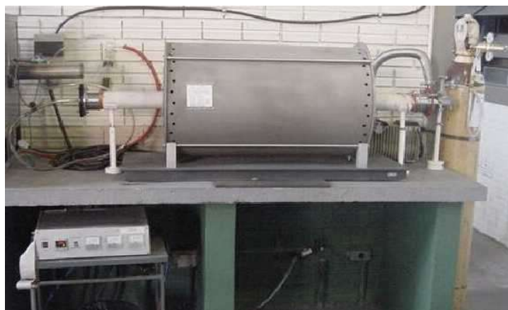
Figura 23: Forno tubular de atmosfera controlada
