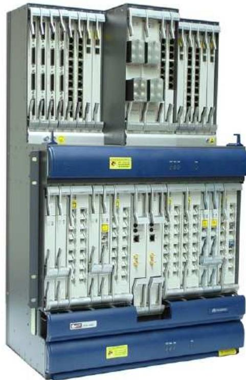
**Figura 12 Equipamento OptiX RTN 3900. [12]**
