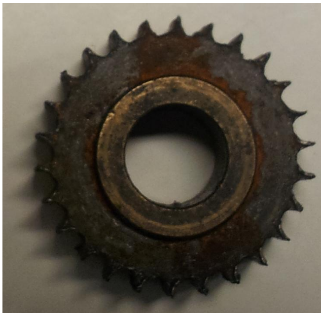
Figura 19 – Engrenagem com os dentes severamente desgastados.
