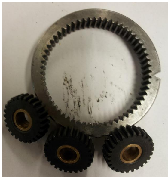
Figura 17 – Engrenagens satélite com pouco desgaste aparente.
