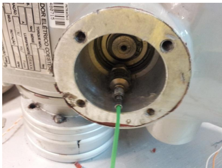
Figura 13 - Instalação do acelerômetro próximo à extremidade do sem fim.
