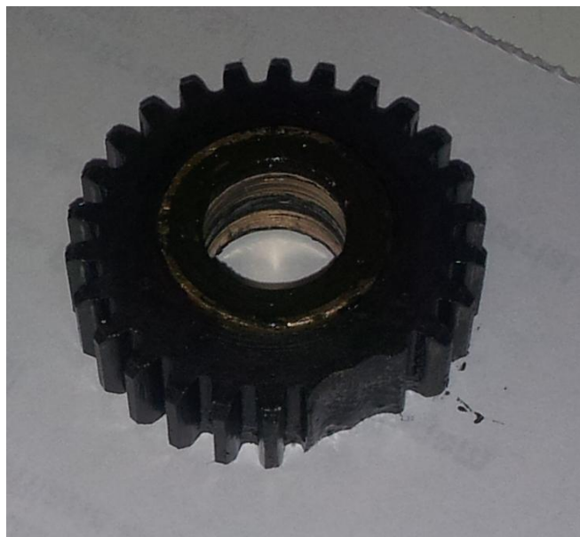
Figura 18 – Engrenagem com 3 dentes quebrados.
