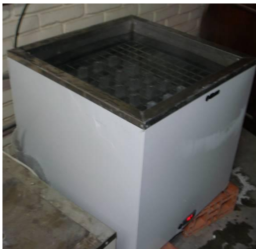
Figura 13 – Tanque de inox com as barras posicionadas em pé imersas em solução
