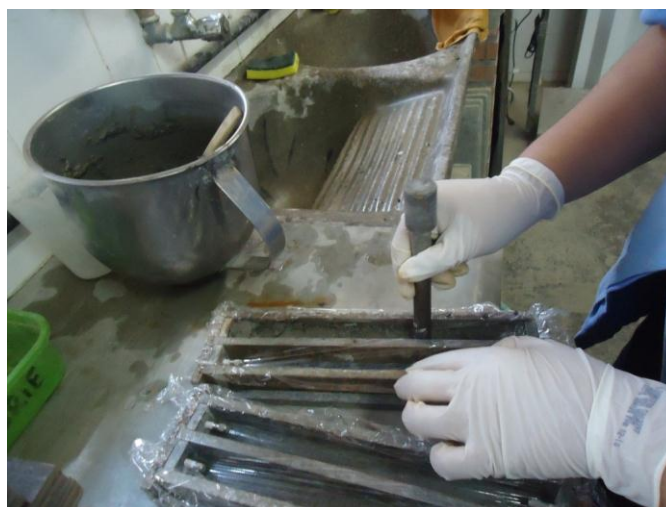
Figura 11 – Moldagem das barras
