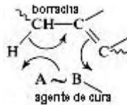
Figura 2.10. Reação ene que ocorre entre a molécula de borracha e o agente de cura na vulcanização. 25
