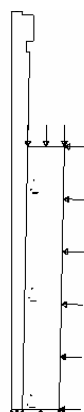
Figura 4.12 – Perfil axi-simétrico para a simulação da retração através da pressão externa uniformemente distribuída.
