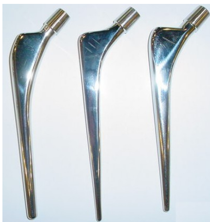
Figura 4.14 – Três próteses no plano frontal. Da esquerda para a direita, modelo A com haste cônica, modelo B com dupla cunha e modelo C com tripla cunha. A prótese B tem menor raio na região de transição. Ampliação: 0,3X.
