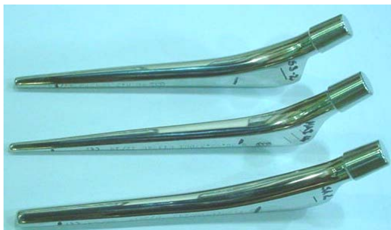
Figura 4.15 – De baixo para cima, modelos A, B e C. O modelo A tem haste cônica. Os modelos B e C apresentam afilamento no plano lateral. Ampliação: 0,5X.
