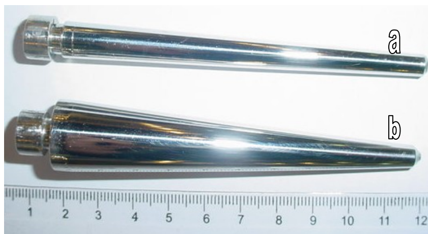
Figura 4.2 – Modelos simulados de hastes femorais cimentadas: a) ângulo de conicidade de 1^{\circ}15' e b) de 4^{\circ} de conicidade.
