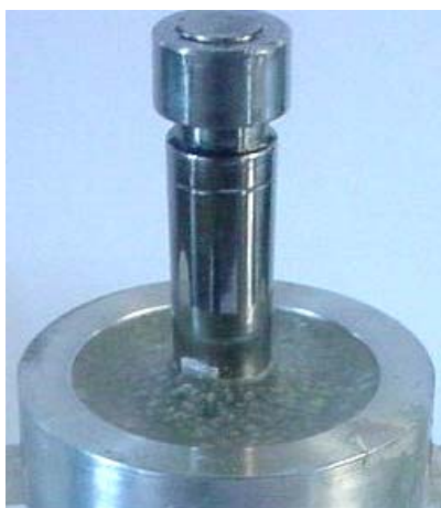
Figura 5.1 – Superfície livre côncava do manto devido a retração da polimerização.
