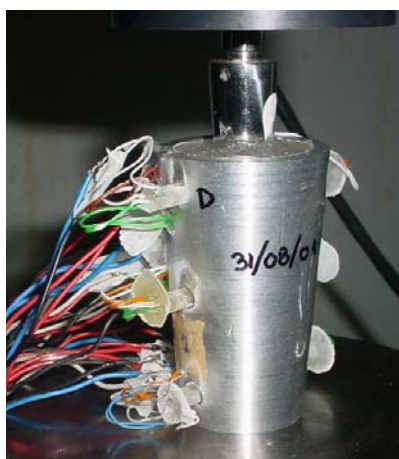
Figura 4.6 – Amostra com haste de conicidade de 4 graus durante o ensaio. A fotografia mostra os dois conjuntos de três dispositivos de medição das deformações diametralmente opostos nos três níveis.
