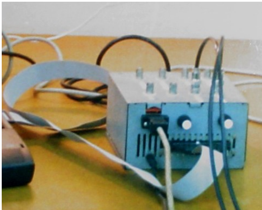
Figura 31: Detalhe da caixa de comando e potenciômetros de ajuste de taxa de amplificação de sinais.
