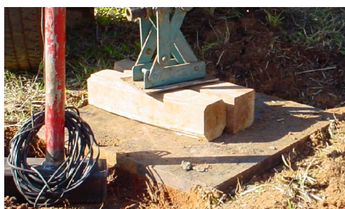
Figura 37: Posicionamento da placa de geração da onda cisalhante
