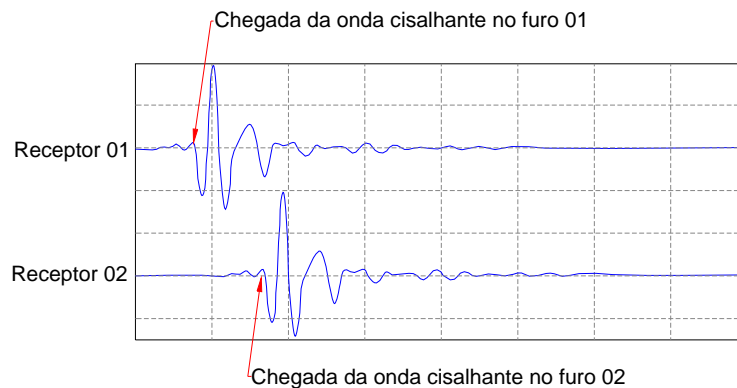
Figura 9: Resultado típico (exemplo) de um ensaio sísmico cross-hole
