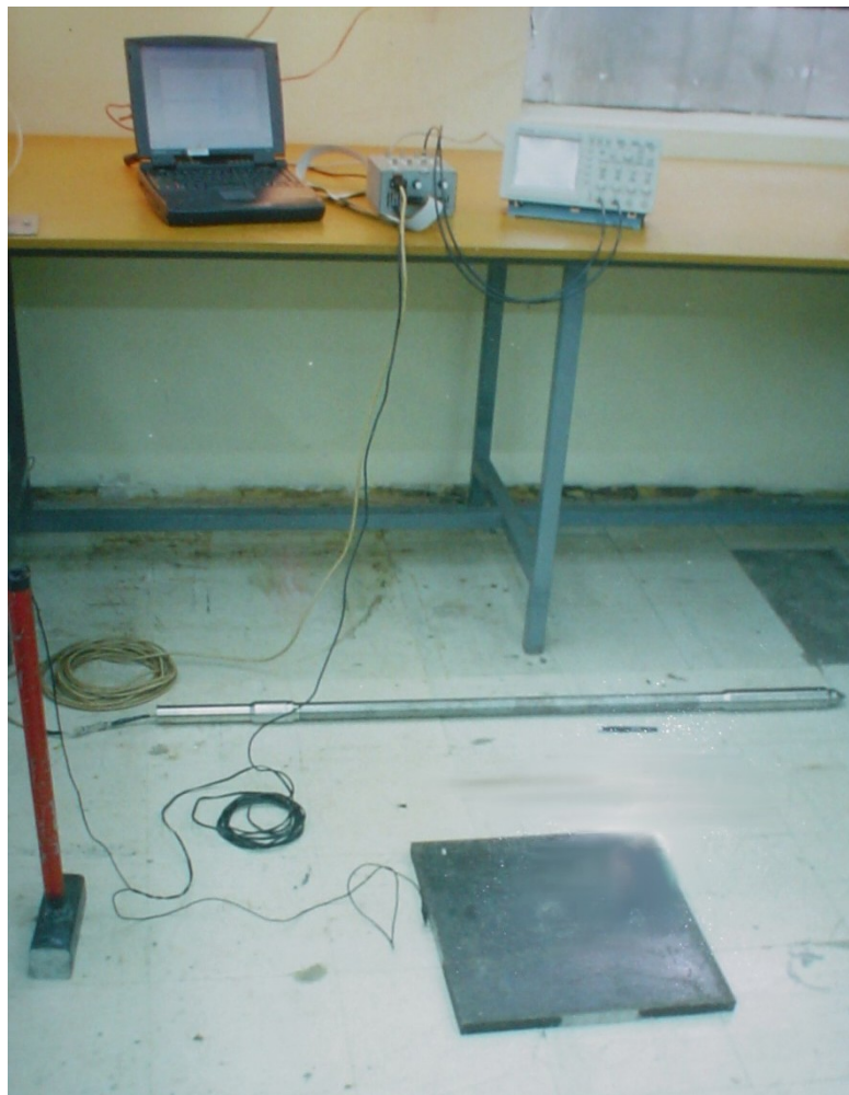
Figura 25: Cone Sísmico da UFRGS em teste no laboratório
