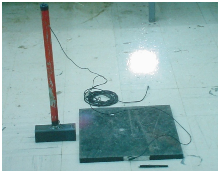
Figura 26: Placa e marreta metálicas em testes de laboratório
