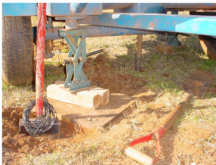
Figura 27: Sistema de geração da onda cisalhante em operação
