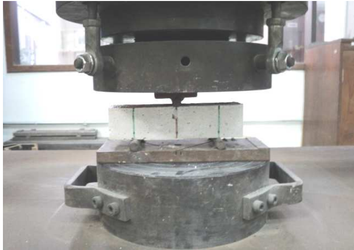
Figura 21 – Rompimento do corpo de prova de argamassa à tração na flexão
