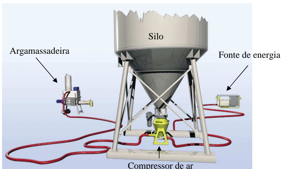
Figura 8 – Sistema de bombeamento a seco de argamassa
