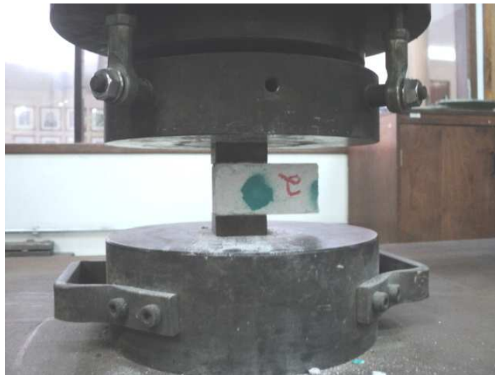
Figura 22 – Rompimento da metade do corpo de prova resultante do ensaio de resistência à tração na flexão para se verificar resistência à compressão
