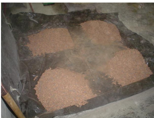
Figura 24 – Redução da amostra inicial pelo método do quarteamo
