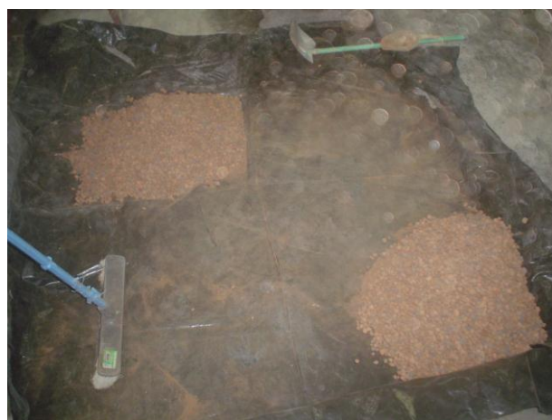
Figura 25 – Exclusão de parte da amostra inicial pelo método do quarteamo
