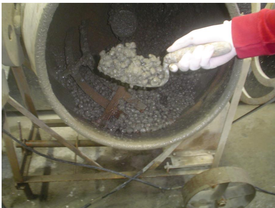
Figura 27 – Aparência do concreto com apenas areia comercialmente denominada como média como agregado miúdo
