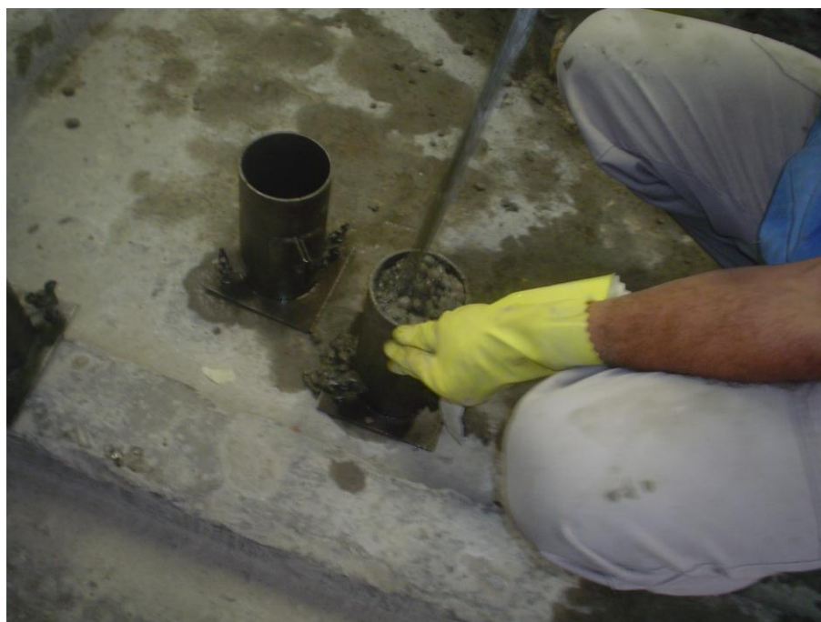
Figura 29 – Processo de adensamento manual
