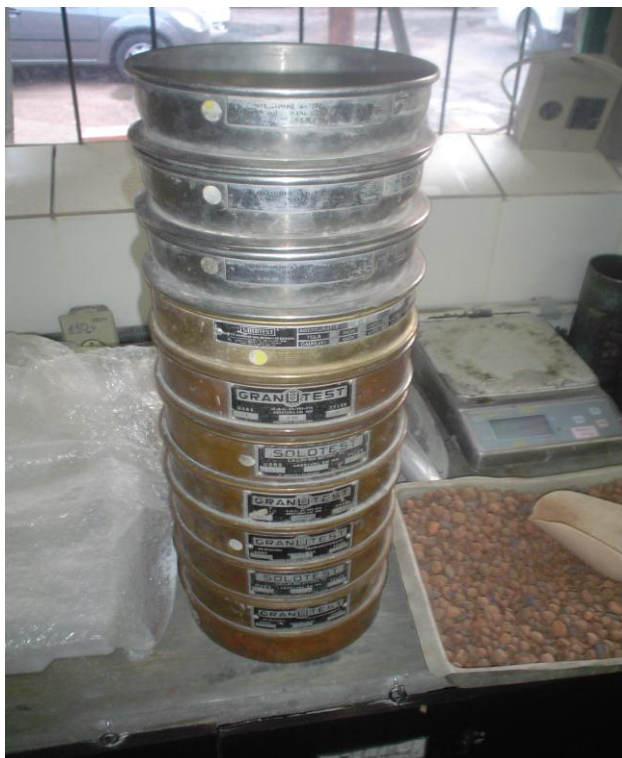
Figura 26 – Sequência de peneiras para análise da granulometria
