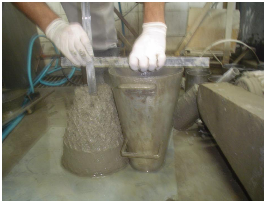
Figura 32 – Verificação do abatimento de tronco de cone
