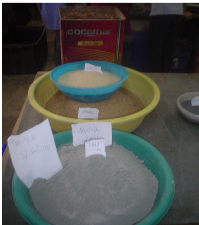
Figura 28 – Materiais separados para mistura em betoneira
