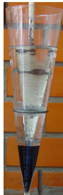
(c) efluente tratado por adsorção/coagulação/floculação
