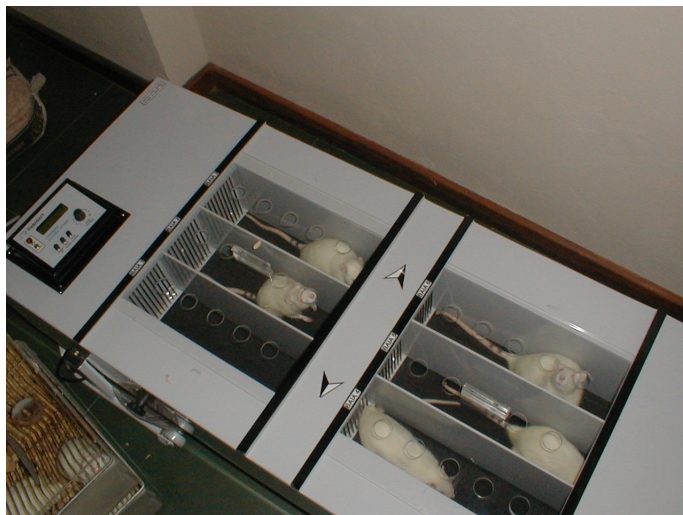
FIGURA 4 – Foto ilustrando a esteira ergométrica utilizada para a prática de exercício forçado em ratos.
