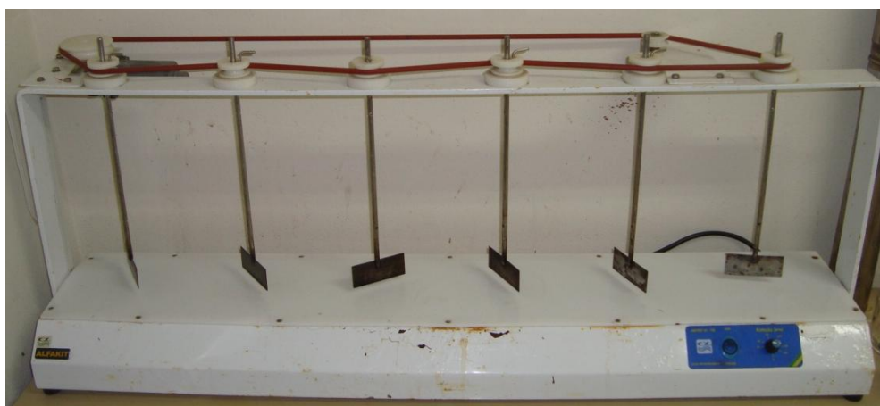
Figura 9: Equipamento para testes de jarros (Jar-test) da marca Alfakit
