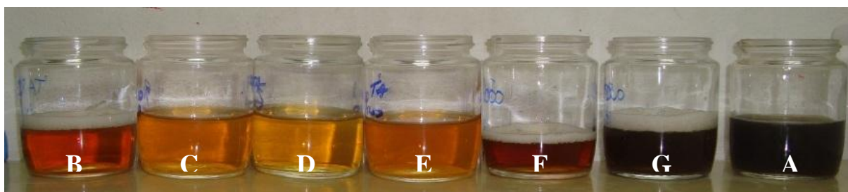
Figura 104: Sobrenadantes obtidos no último ensaio utilizando o tanino com ajuste de pH do efluente do RSB2 em 5,5 (A: efluente do RSB2; B: 6000; C: 8000; D: 10.000; E: 12.000; F: 14.000; G: 16.000 mg/L)
