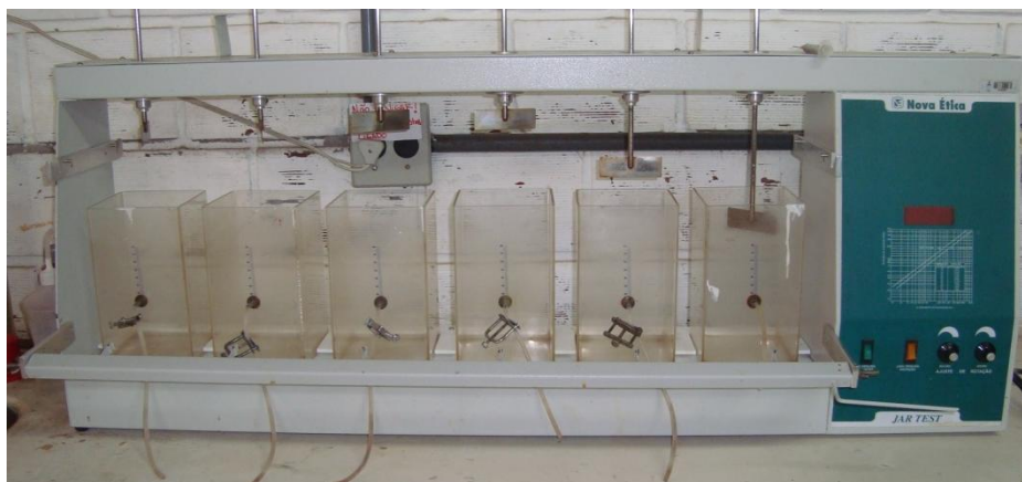
Figura 11: Equipamento para testes de jarros (Jar-test) da marca Nova Ética
