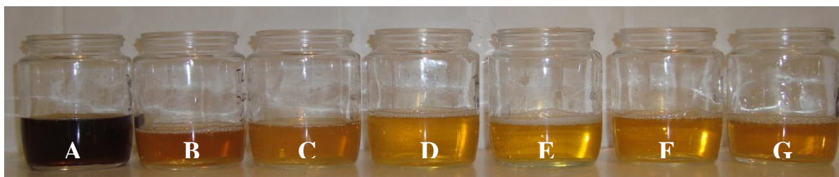
Figura 50: Sobrenadantes obtidos no último ensaio utilizando o tanino com ajuste de pH do lixiviado bruto em 5,4 (A: lixiviado bruto; B: 5000; C: 8000; D: 11.000; E: 14.000; F: 17.000; G: 20.000 mg/L)
