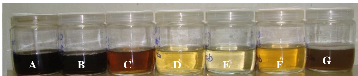
Figura 32: Sobrenadantes obtidos no último ensaio utilizando o cloreto férrico com ajuste de pH do lixiviado bruto em 6,2 (A: lixiviado bruto; B: 344; C:689; D: 1033; E: 1102; F: 1377; G: 2066 mgFe +3 /L)
