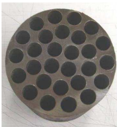
Figura 3.13 Distribuição de furos na seção transversal.
