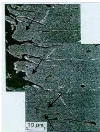
Figura 2.22 Inclusões metálicas de bismuto associadas à micro trincas na formação do cavaco, durante a usinagem de um aço com 0,20% Bi à velocidade de corte de 120 m/min. (3)
