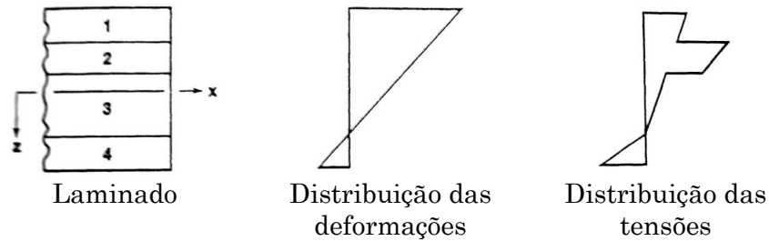
Figura 8: variação de tensões e deformações ao longo da espessura de um laminado (baseada em JONES, 1999)
