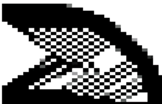
Figura 5.1 – Instabilidade de tabuleiro.
