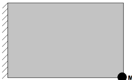
Figura 9.1 – Viga com massa concentrada.
