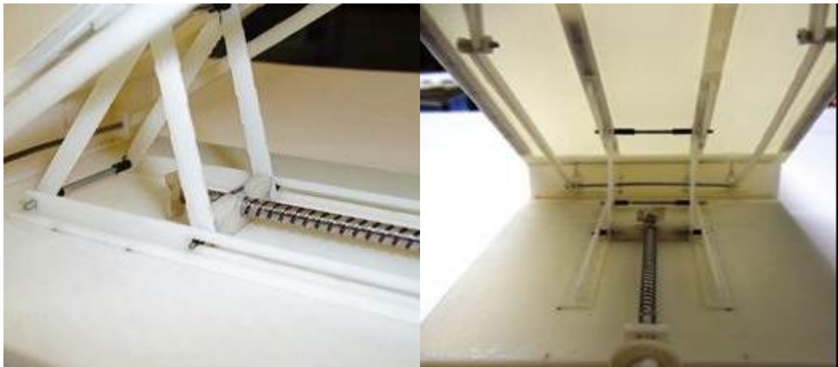
(a) (b) Figura 5.6 – (a) e (b) Alterações de peças colocadas em aço.
