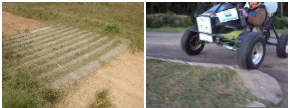
Figura 7.2 – Testes. (a) Costeletas presentes nas provas oficiais (b) Teste realizado com o intuito de recriar as condições da prova
