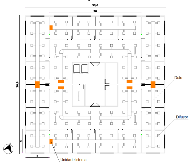
Figura E.1 – Planta baixa e configuração de dutos e difusores
