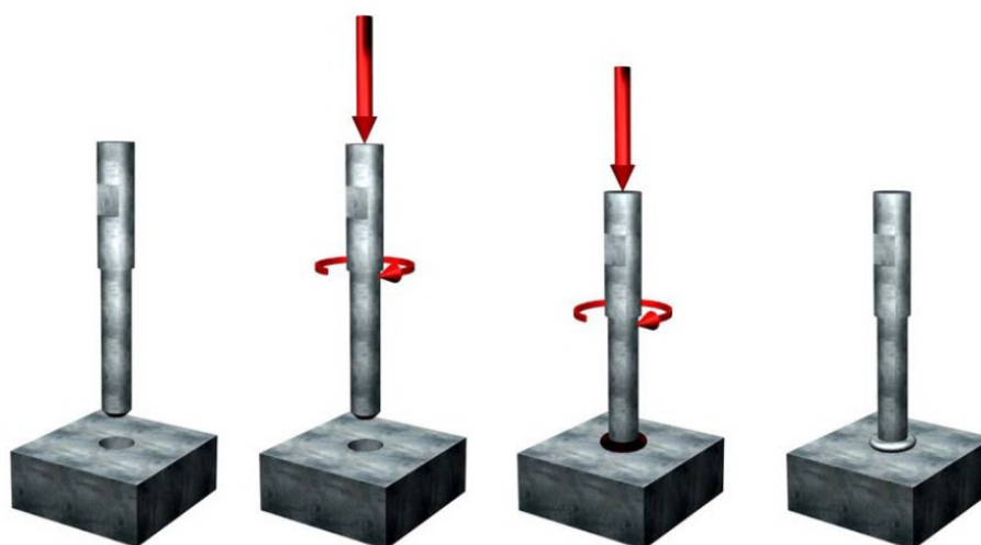
Figura 3.6 Ilustração esquemática do processo de soldagem por atrito com pino consumível. Adaptado de (UNFRIED 2010).
