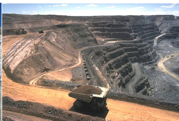
Figura 1b: Método de lavra por bancadas em cava de carvão mineral (fonte: www.eoearth.org/files/147701_147775/strip_coal_mining.jpg )
