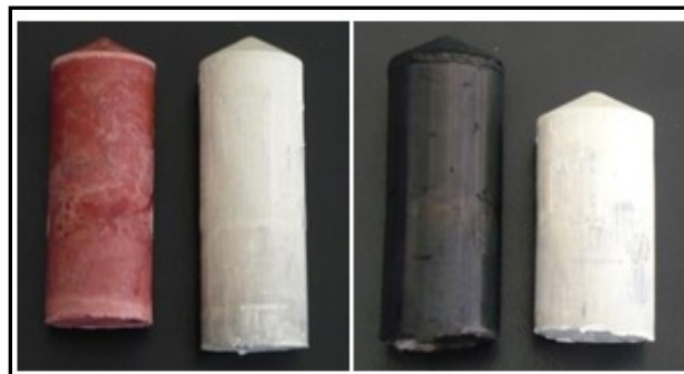
Figura 4.7 Cilindros prensados: MCC (rosa), PZT (branco) e NF (preto).
