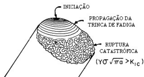
Figura 2.28 - Estágio de propagação de trinca de fadiga. (Adaptado a FERREIRA 2008)
