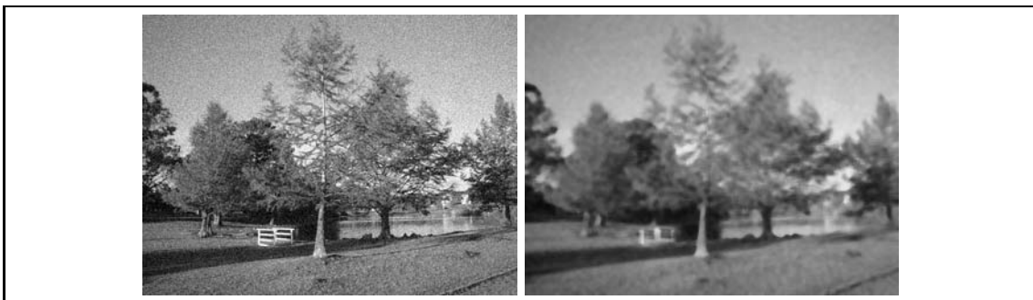
Figura 5.15: A esquerda é apresentada a imagem original com ruído e a direita a imagem resultante do filtro de mediana de máscara 9x9
