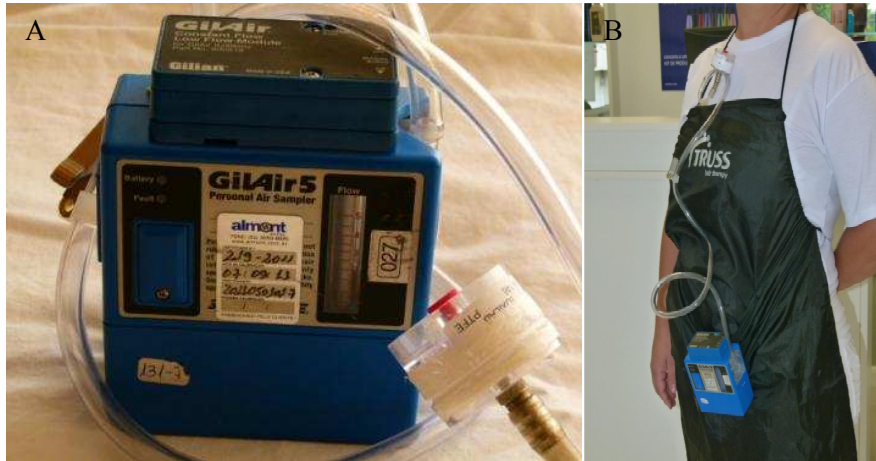
Figura 1. A) Bomba utilizada para a coleta de formaldeído no ar ambiente durante o procedimento. B) Posicionado do equipamento na cabeleireira.
