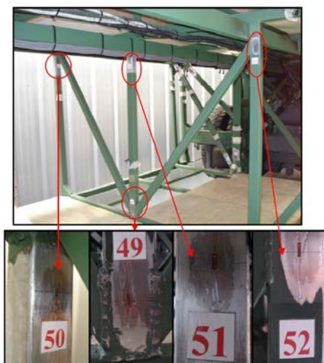
Figura 4.23 Extensômetros fixados na carroceria
