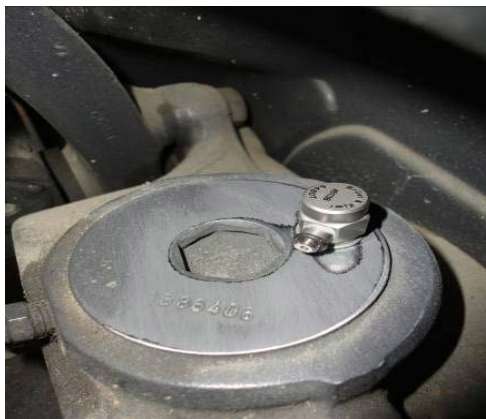
Figura 4.11 Fixação do acelerômetro roda dianteira
