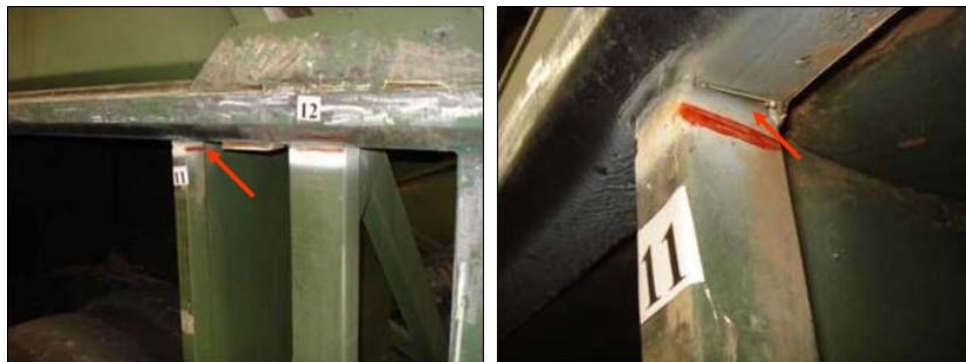
Figura 6.39 Trinca na carroceria frente ao rodado traseiro
