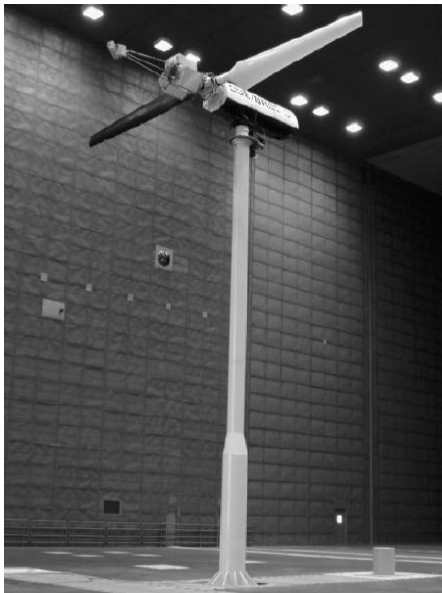
Figura 5.2 – Turbina montada na seção de testes
