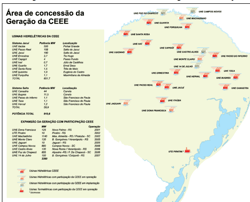
Figura 3 - Área de Concessão da CEEE-GT: Segmento de Geração
